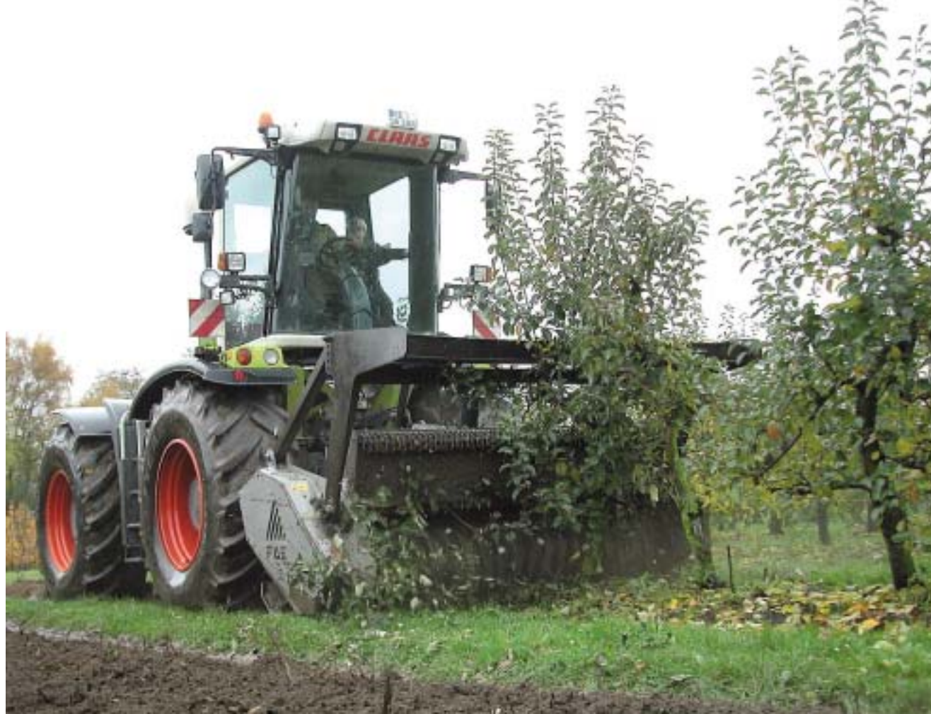
20 Tonnen Eigengewicht, 380 PS und 100 rotierende Messer. Da hatten die 1200 Apfelbäume auf der Plananlage von Eberhard Schmücker keine Chance. Fotos: Franz Naskrent
